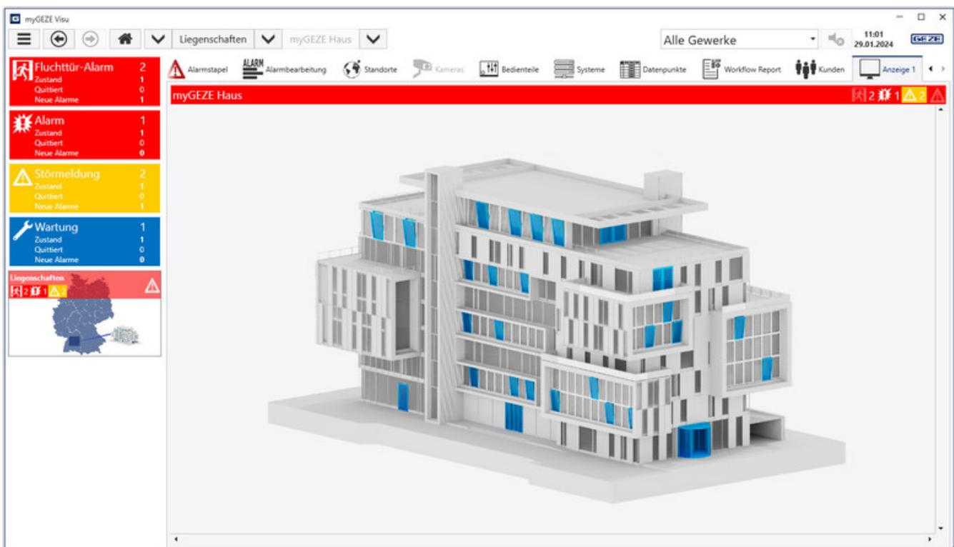
Gebäudemanagementsystem zur Visualisierung, Bedienung, Steuerung und Überwachung von angebotenen GEZE-Produktsystemen
