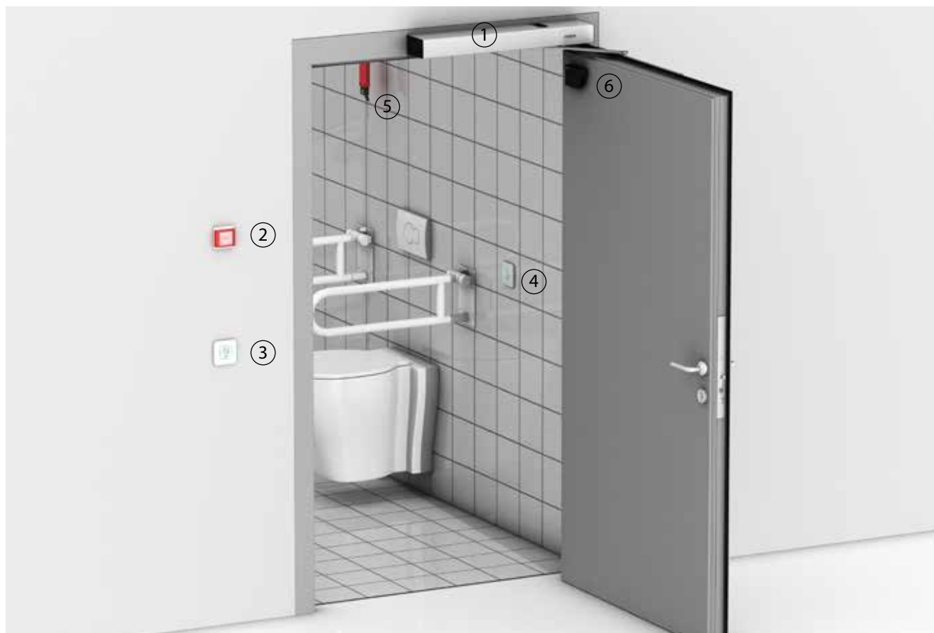
1 = Drehtürantrieb | 2 = Not-Auf-Schalter (Empfehlung Installationshöhe: 1600 mm) | 3 = Berührungsloser Näherungstaster (UP) | 4 = Berührungsloser Näherungstaster (AP) | 5 = Zugschalter Notruf | 6 = Laserscanner
