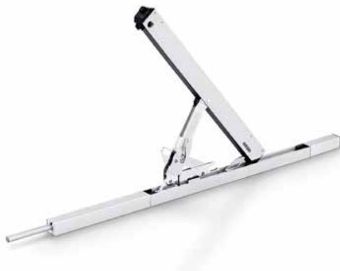
Aufliegender Flachform-Oberlichtöffner mit einer Öffnungsweite von 320 mm
